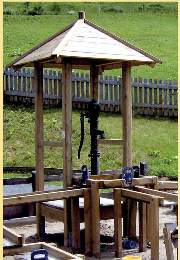
Die Pumpe ist so konzipiert, dass sie normal an die Wasserleitung angeschlossen werden kann und bei gehobenem Pumpenschwengel läuft das Wasser; sobald der Pumpenschwengel gedrückt wird, wird die Wasserzufuhr gestoppt.
